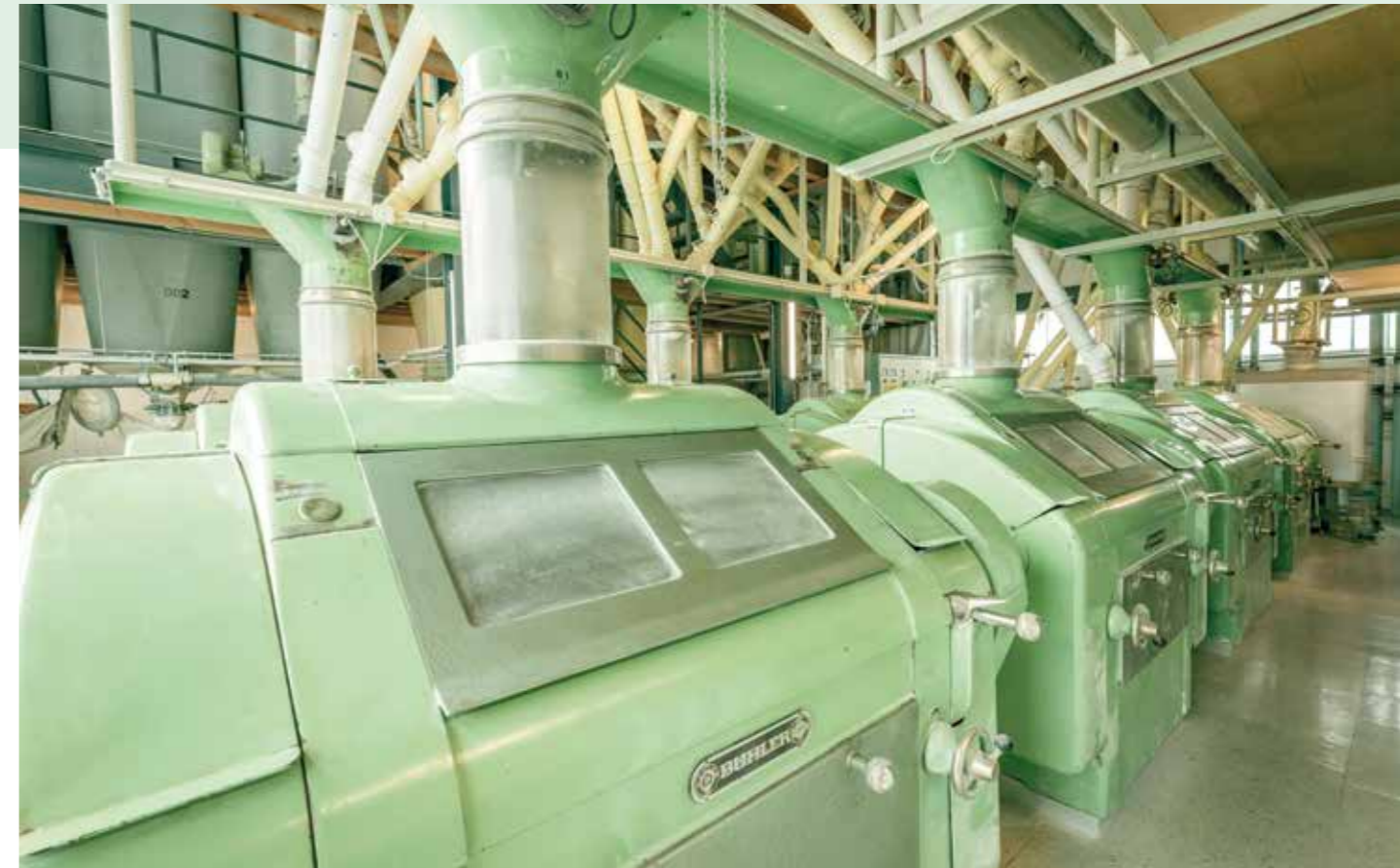
Getreidemühle von Flums Dorf mit einer Leistung von 50t/24h
